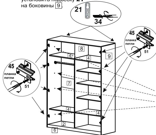
**Внимание:** Если вам необходимо стянуть между собой рядом стоящие шкафы, то на боковинах **[9]** нужно досверлить отверстия сверлом  $d=5\text{мм}$ , и стянуть рядом стоящие боковины стяжкой **52**. При этом на боковину идет по две стяжки, поэтому перед засверлкой необходимо определиться с уровнем высоты, на котором будет производиться стягивание, соответственно те отверстия и досверлить.
